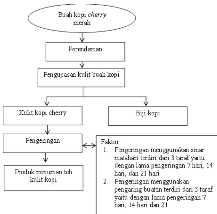
Gambar 1. Proses Pembuatan kopi cascara
