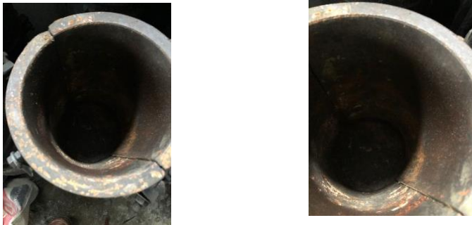
Gambar 4. Kondisi Karat Pada Cetakan Beton dengan Komposisi Cocopeat 25% (Riset, 2021)
