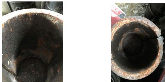
Gambar 6. Kondisi Karat Pada Cetakan Beton dengan Komposisi Cocopeat 75% (Riset, 2021)
