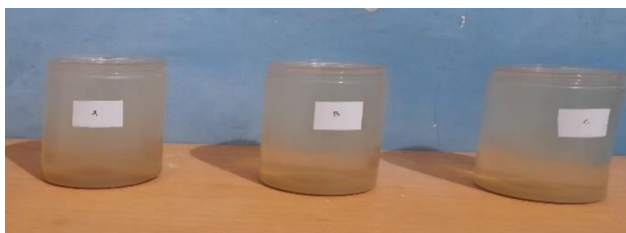
Gambar 4. Sampel Air Asam Tambang setelah penetralan menggunakan kapur tohor
