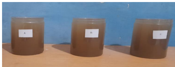
Gambar 3. Sampel Air Asam Tambang sebelum penetralan menggunakan kapur tohor
